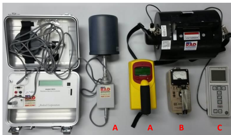
Figura 1 – Câmaras de ionização (A), detector Geiger Müller (B) e detector de nêutrons (C)
